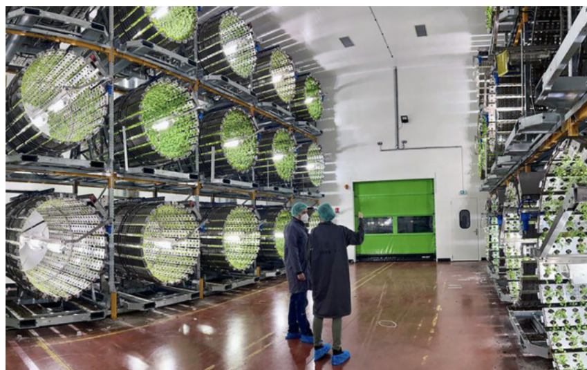
La ferme verticale de l'agritech Futura Gaïa est installée à Tarascon dans les Bouches-du-Rhône. La "salle de croissance" s'élève sur trois niveaux d'un système de géoponie rotative — Photo : Futura Gaïa
